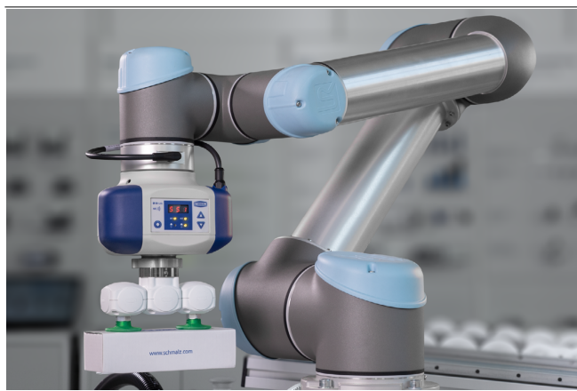
Электрический вакуум-генератор ECBPi при перемещении картонных коробок
